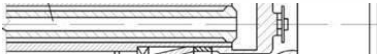
РИС. 1.9. ГОЛОВКА РОТАЦИОННОЙ ФОРСУНКИ: 1- ТОПЛИВОПОДАЮЩАЯ ТРУБА; 2- ПОЛЫЙ ВРАЩАЮЩИЙСЯ ВАЛ; 3 – КОРПУС; 4 – ПИТАТЕЛЬ; 5- ВРАЩАЮЩИЙСЯ РАСПЫЛИВАЮЩИЙ СТАКАН; 6 – ЗАВИХРИТЕЛЬ ПЕРВИЧНОГО ВОЗДУХА
